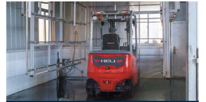
IPX4 방수 등급: 차량 키운 후 폭우 테스트 (15분간 5000L), 차량 정상 작동
