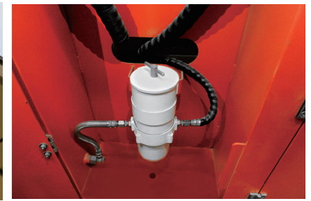
■ 오일 주입구 및 리턴 파이프를 고무 호스 대신 강선으로 감긴 파이프 사용: 안전 등급이 대폭 향상
